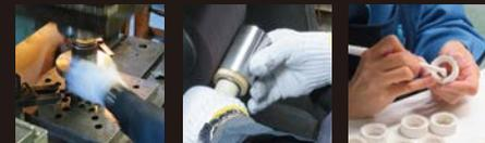
ステンレス板から型抜きを行い、その後成型を繰り返しながら最終の細さまで絞ります。
