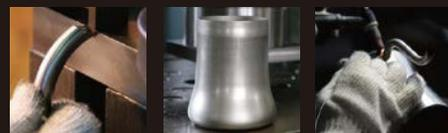
ベンダー加工からNC切削によるウェーブカット。最後に先端をプレスし、さらに注ぎ易く。
