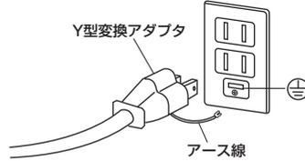
**⚠️ ご注意** 電源コードをY型変換アダプタに変更した時は、必ずアース線を接続してご使用ください。
