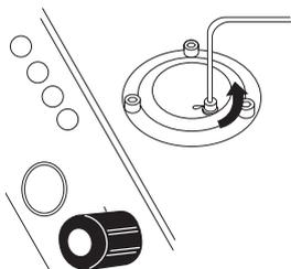
**3** 六角ボルトを再度締め付けて、天板(カバープレート)を取付けてください。
