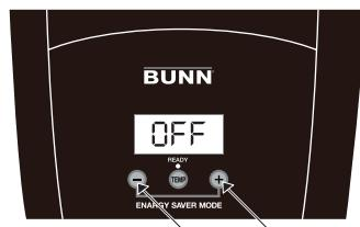
+ / - ボタンを 2 回押すとディスプレイに OFF と一瞬表示され、温度表示が点滅状態になります。
