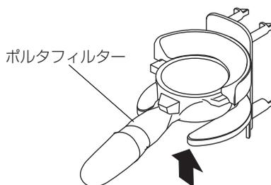
**3** モジュールロックを押しながらポルタフィルターモジュールの上下に気を付けてモジュール固定部分に取り付けてください。
