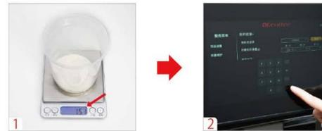
ステップ9：トレイを左のパウダー排出口に戻し、「起動」スイッチを押して二回目のキャリブレーションを行います。計量後マシンに記録します。
