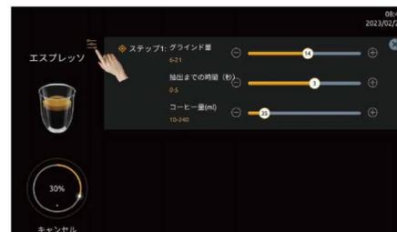
ステップ4：画面上の調整レバーをドラッグすると、量を一時的に調整することができます。(調整可能モード時のみ使用可能)
