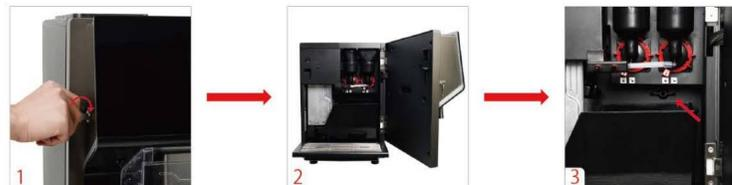
ステップ2：図のように上カバーを外して、パウダーの排出口のロックブロックを回して外します。左右のミキサーを取り外します。
