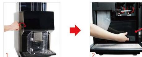
ステップ2：図のように、ミキサーの上カバーを外します。赤いロックキーを反時計回りに回してミキサーを取り外します。この時、パウダーホッパー下の排出口が開いていることを確認します。
