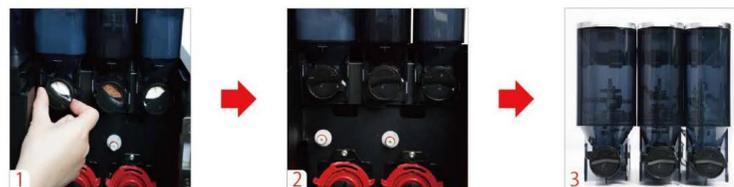
ステップ4：調整ハンドルを時計回りに回して左パウダーホッパーの蓋を開けてマシン専用のパウダーを充填します。左パウダーホッパーを元の位置に戻して蓋をロックします。中、右パウダーホッパーも同じ手順で充填します。
