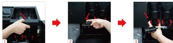
ステップ3：パウダーホッパーを左、中、右の位置に設置します。次にパウダーホッパー下部にある排出口の蓋を開放し、ミキサーを設置します。最後に上カバーを被せます。
