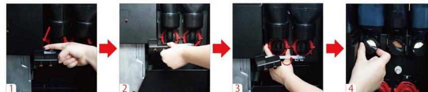
ステップ3：画面上の操作で「パウダーキャリブレーション」を選択します。マシンの鍵を時計回りに回して扉を開きます。赤いロックキーを反時計回りに回してロックを解除し、ミキサーを取り外します。パウダーホッパー下部のパウダー排出口にパウダーを受け取るトレイを近づけ、パウダーが飛び散らないようにします。画面上で「スタート」を押すと、排出口からパウダーが出ます。動作が終了したら、パウダーの重量を計測して「第1回目」に記録します。※「第2回目」、「第3回目」のキャリブレーションも同じ手順で行ってください。
