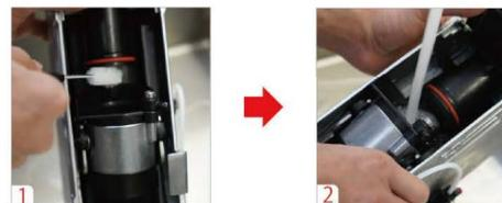
ステップ4：ユニット本体を元の位置に戻してホルダーを上押し込みます（カチッと音がなったらセット完了）。
