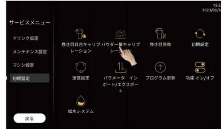
ステップ7：「左パウダーホッパー」を選択し、「スタート」ボタンを押します。パウダーが完全にトレイに落ち、マシンが停止するまで待ちます。
