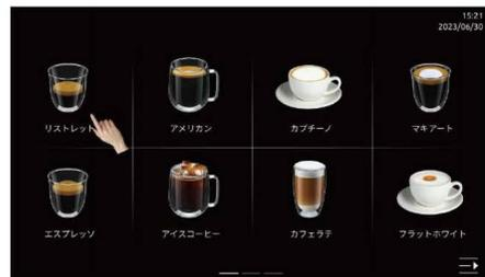
ステップ3：ドリンク制作中に画面の「
