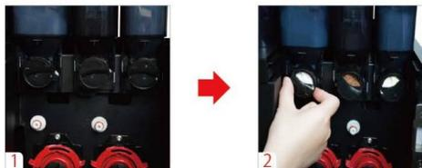
ステップ7：ミキサーを元の位置に戻します（パウダーの付着を防ぐため、ミキサーの乾燥を徹底してください）。
