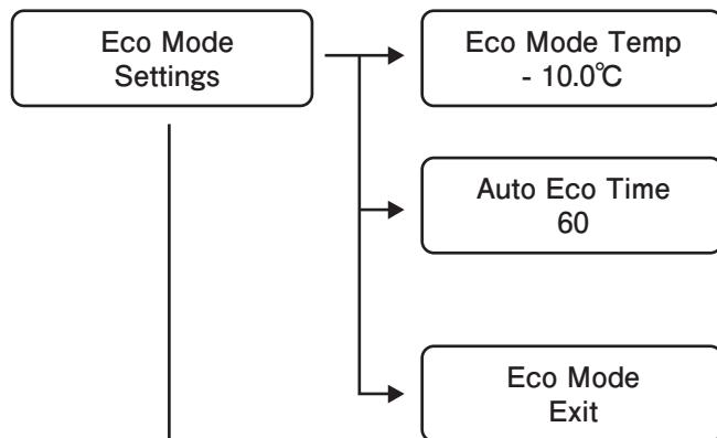
**エコモード時の制御温度を設定できます。**ボイラー設定温度からの差で値を設定します。
