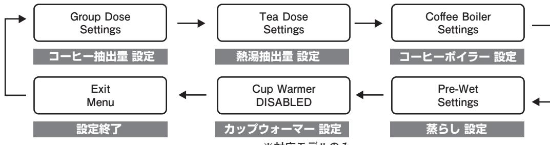
各項目の設定を行うには、設定したい項目がディスプレイに表示されている時にT3ボタンを押します。
