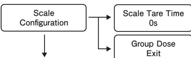
抽出ボタン押下後、計量リセットを行うまでの時間を設定できます。
