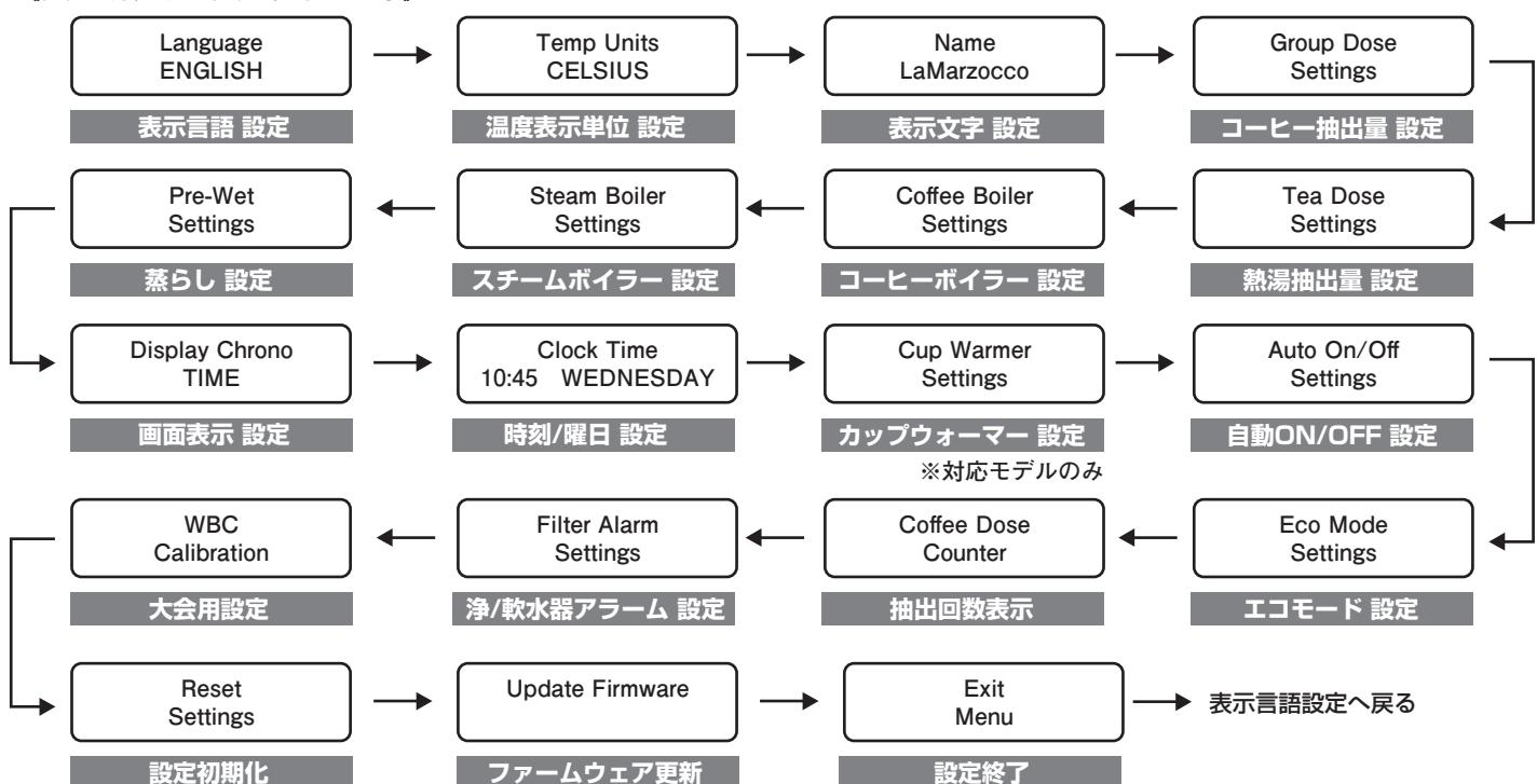
各項目の設定を行うには、設定したい項目がディスプレイに表示されている時にT3ボタンを押します。
