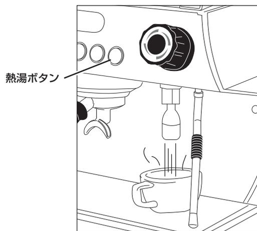
**⚠ 注意** カップを持ったまま熱湯を押下しないように注意してください (熱湯が飛び散り火傷の恐れがあります)
