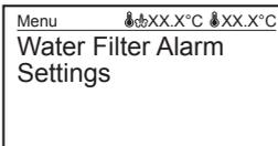
浄水器のメンテナンスや交換の必要性をユーザに警告するアラームを設定できます。設定量に達すると、エラーメッセージ "Filter Alarm" が表示されます。開始時間 0 (ゼロ) は、浄水器アラームを無効にします。
