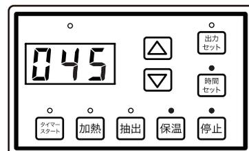
上図で停止ボタンを押すと保温時の出力が 45 % で設定できます。
