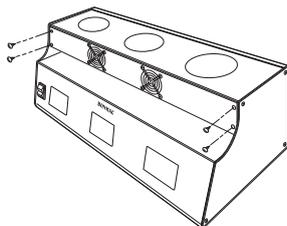
本体前面の冷却ファンがついている板のネジ4本を反時計方向に回し外してください。
