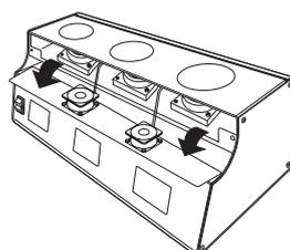
冷却ファンが取り付けられているカバーを手前に倒し、そのまま本体上に置いてください。ファン部の汚れを綿棒などで拭き取り、元通りネジ4本で固定してください。
