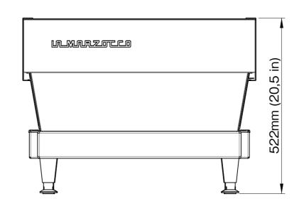
LA·MARZOCCOエスプレッソコーヒーマシン LINEA Classic S-2 外形寸法(mm) 幅693/奥行585/高さ522 重量(乾燥重量) 電源:消費電力 単相200V:50/60HZ 3730W 19A ボイラー容量 コーヒー:3.4ℓ/スチーム:7ℓ エスプレッソ抽出能力 400杯/h(注1) 熱湯抽出能力 16ℓ/h 初動沸き上がり時間 20分 給水ホース 約2m (注2) 電源コード 約1.8m (注2) ポンプ電源コード 約1.8m (注2) コンセント形状 20A (--)
