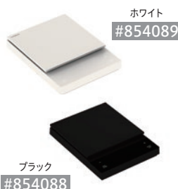
HARIO POLARIS ケース入数 20 電源・消費電力 単3型乾電池3本 寸法 W127×D165×H28mm 重量(約) 437g 表示単位 グラム(g) 最大秤量 2,000g 最小表示 0.1g ブラック JAN:4977642 027206 ホワイト JAN:4977642 027107
