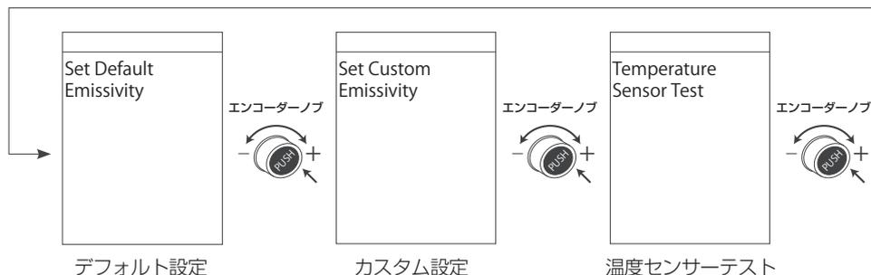
エンコーダーノブを**Diagnostic Test Settings**が表示されるまで回し、エンコーダーノブを押してメニューにアクセスします。
