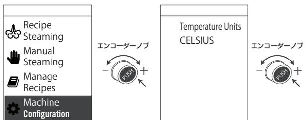
エンコーダーノブを**Temperture Units**が表示されるまで回し、エンコーダーノブを押してパラメータにアクセスします。
