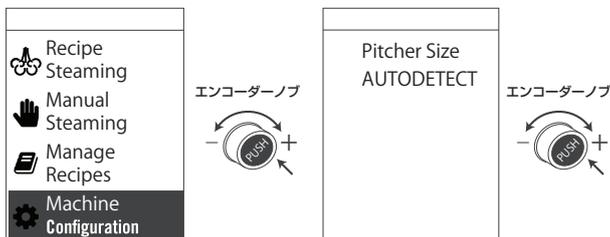
エンコーダーノブを回して**Machine Configuration**を選択し、エンコーダーノブを押して決定します。
